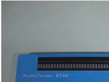
点字ピンディスプレイ（左）とその触知盤の拡大図（右）
