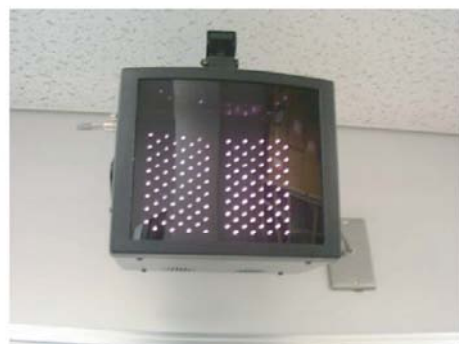
赤外線補聴システムの赤外線ラジエター
