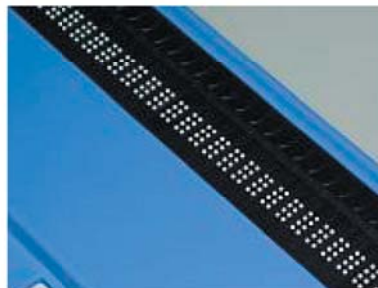
点字ピンディスプレイ（左）とその触知盤の拡大図（右）
