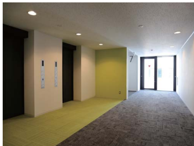
図-3-8-2 エレベーター前の床壁面の色が着床階を認識させる
