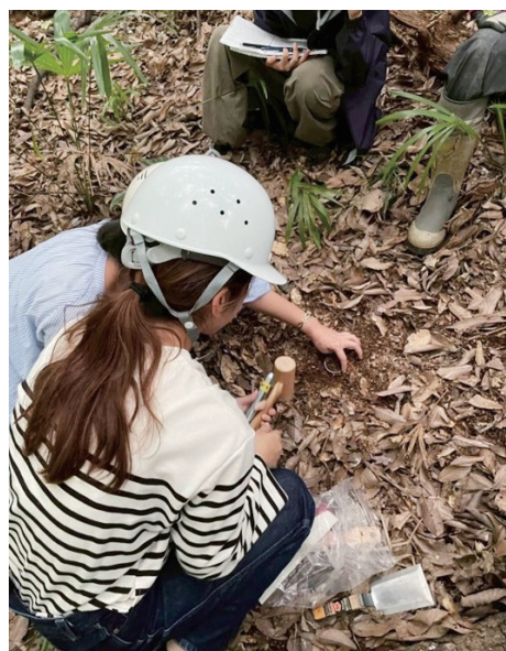
写真2 土壌採取の様子(土の中に土壌円筒と呼ばれる器具を埋めていきます。いったん埋めた円筒は、このあと非破壊で取り出します。)
