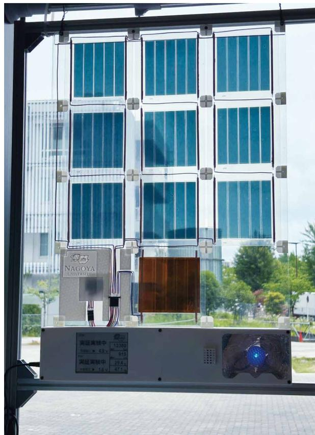
カーボンナノチューブ電極を用いた太陽電池(NIC館ガラス面に設置。CNT-OPV9枚、CNT-PSC1枚。2025年3月11日から開始。)
