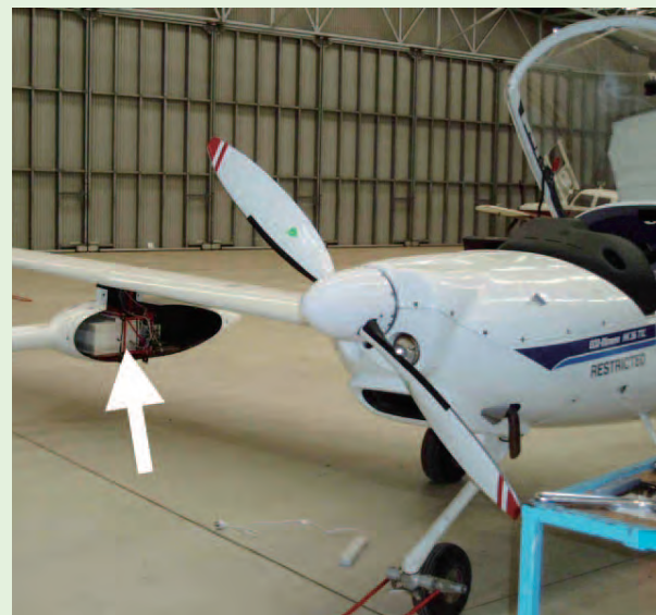
気球搭載二酸化炭素計測器の小型飛行機による測定実験の様子 ※矢印が開発中の装置です。
