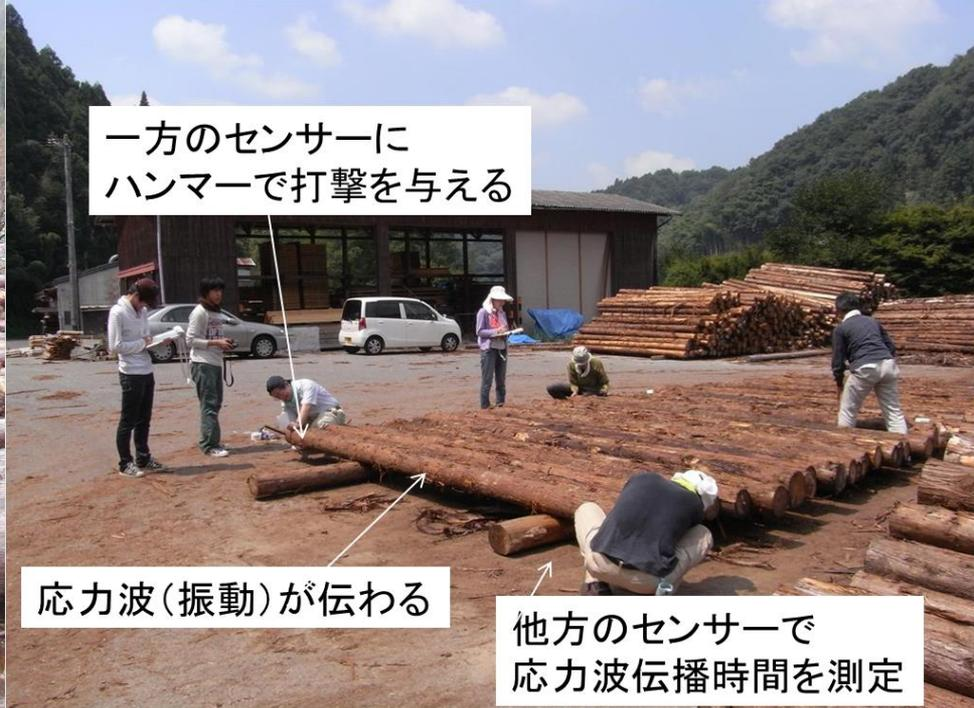
一方のセンサーにハンマーで打撃を与える
