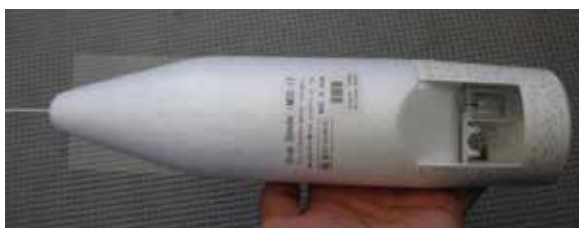
図5: 航空機観測で使用するドロップゾンデの本体。名古屋大学と明星電気株式会社で開発したもので、本体はトウモロコシから作った生分解性素材でできている。右端に温度と湿度センサーが見えている
