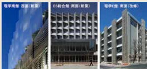
建築的工夫による省エネ対策：日射遮蔽材の設置例
